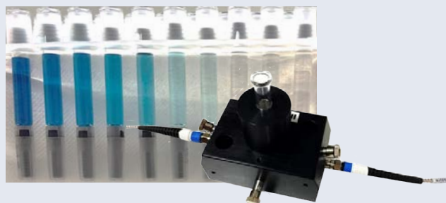
Figure 1 : Seringues contenant des solutions de bleu de méthylène à différentes concentrations, ainsi que le porte-seringue permettant de les mesurer d'une façon répétable.
