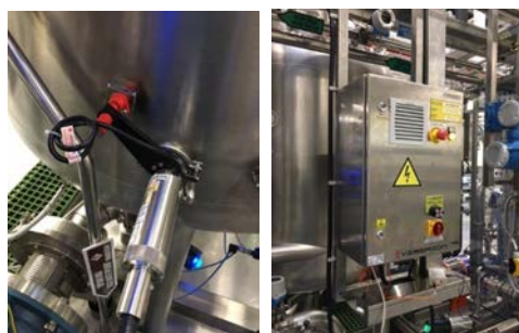
Figure 4 : Intégration du système Raman
